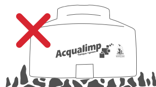
Base com materiais cortantes
